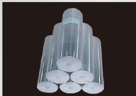
押出加工用ビレット (AM60+2Ca, 6インチ×400mm)
