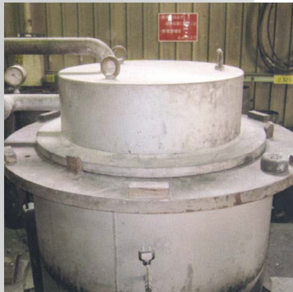
難燃性マグネシウム合金の溶解・精製装置 (容量100kg / チャージ)
